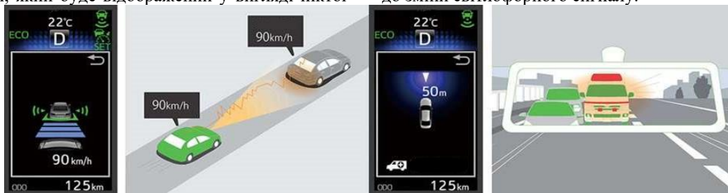
Рисунок 4 – Дві функції ITS Connect використовують зв'язок із сусідніми машинами (V2V) [15]
