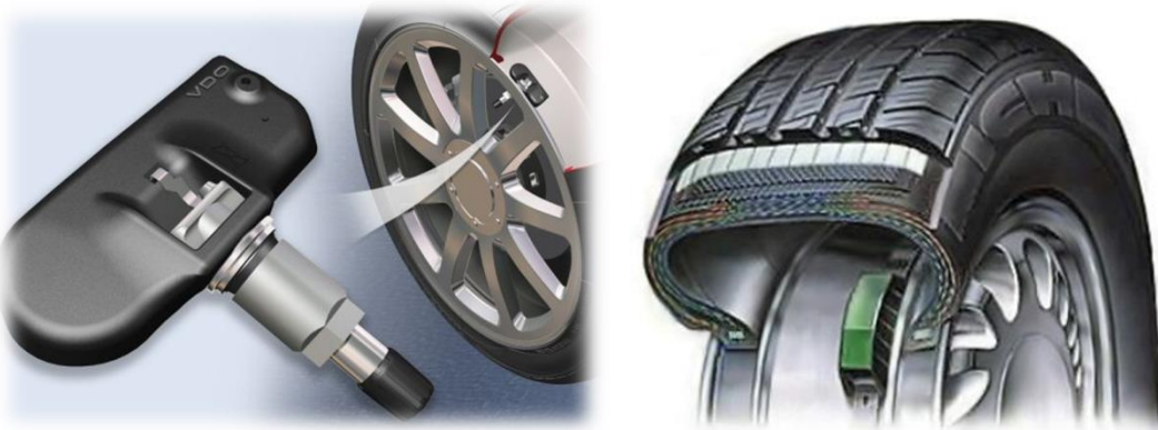
Рисунок 6 – Системи контролю тиску: а) – датчик на клапані; б) – датчик тиску на обід диску [18]
