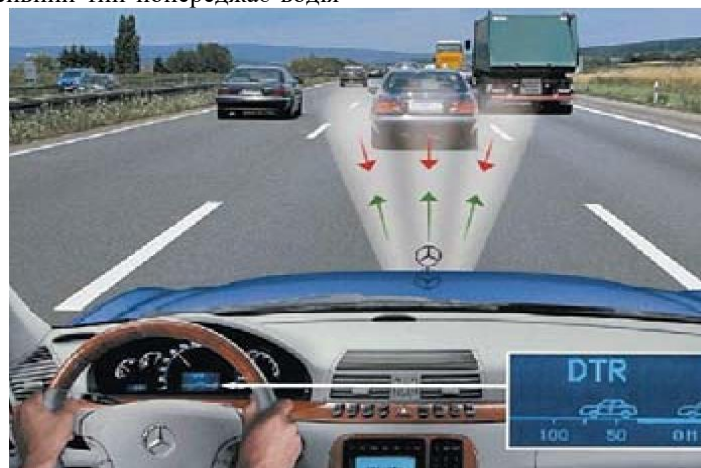
Рисунок 2 – Аналіз достовірності сигналу датчика на системі круїз-контролю досить вузький і призначений тільки для того, щоб стежити за смугою руху, якою рухається автомобіль [11]
