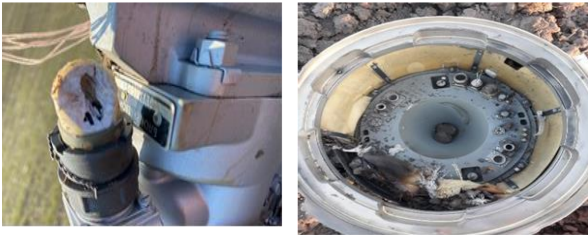
Рис. 4. Зовнішній вигляд блоку керування (справа); Зовнішній вигляд відсіку наведення (зліва)
