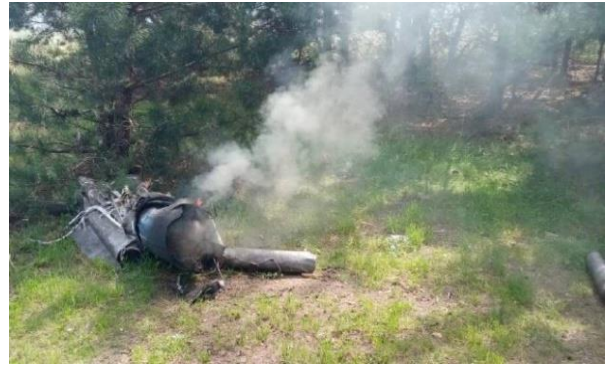
Рис. 2. Зовнішній вигляд уламків керованої ракети Х-31ПМ [20].
