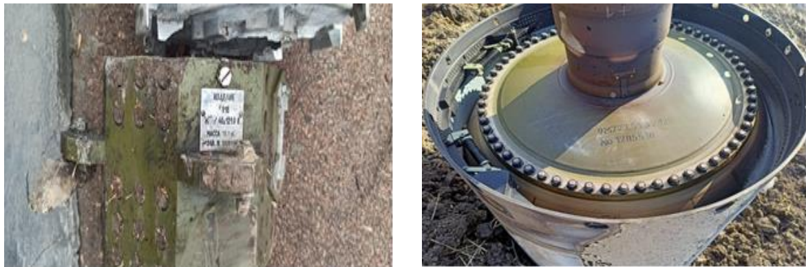
Рис. 5. Елемент головки самонаведення (справа); Зовнішній вигляд двигуна ракети (зліва)
