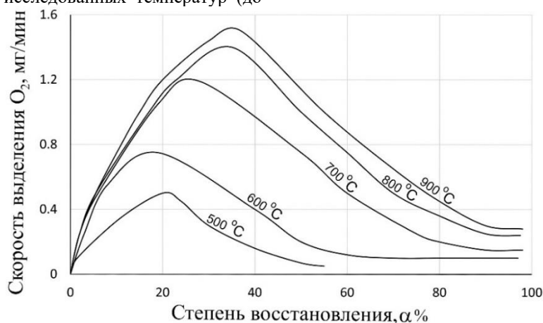
Рис. 1. Кинетические кривые восстановления катализатора 4\text{Co} - \text{Mn} / \text{Al} - \text{Ca}
